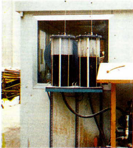
صورة رقم (٤) توضح جهاز قياس الاضافات السائلة للخرسانة وعداد قياس المياه في الخلط
