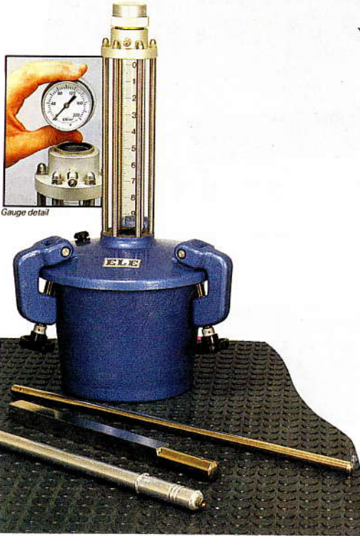
صورة رقم (٧) توضح جهاز قياس النسبة المؤية لحجم الهواء في الخرسانة
