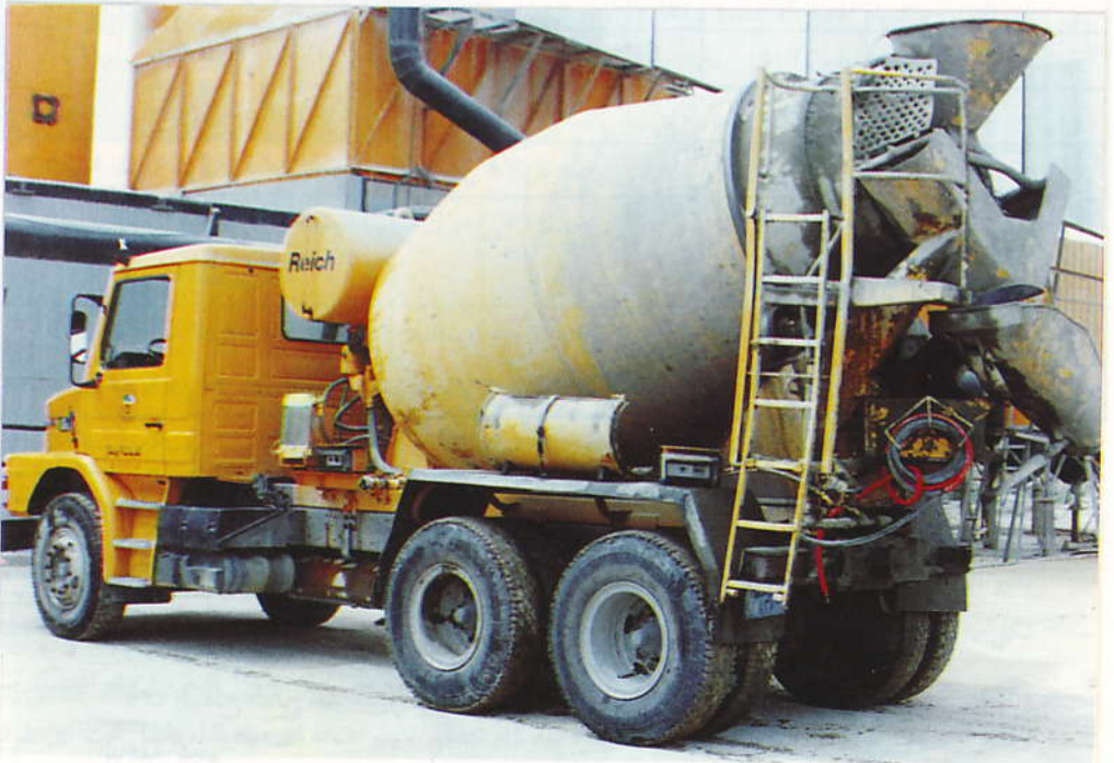
صورة (٦) توضح سيارة نقل الخرسانة الجاهزة من المحطة الى موقع الصب
