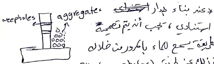
عند بناء جدار استنادي، يجب أن يتم تصفية بطريقة تسمح للماء بالمرور من خلاله ويتم ذلك عن طريق (weephole) والتي تسمح للماء بالعبور من خلال الجدار، ويتم وضع (aggregate) قبل الجدار بحيث تعمل ك (filter) للحواد.
