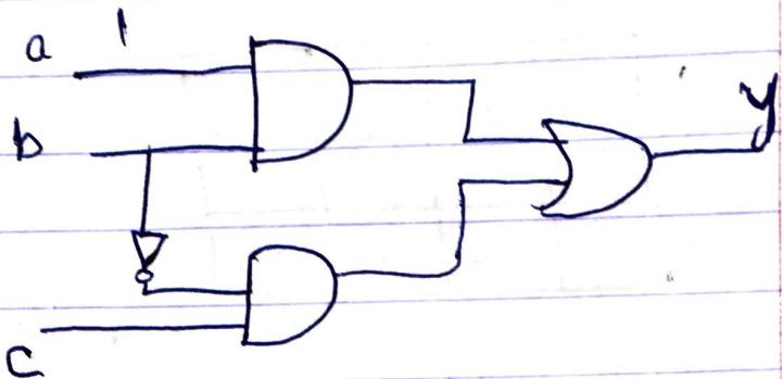
$$1 \quad a=c=b=1 \quad \text{static output } y=1$$
