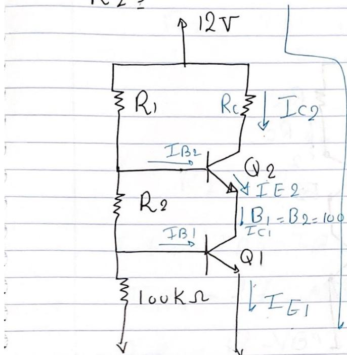
$$-12 + I_{C2} R_C + V_{CE2} + V_{CE1}$$
