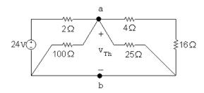
$$\frac{v_{\rm Th}}{100} + \frac{v_{\rm Th}}{25} + \frac{v_{\rm Th}}{20} + \frac{v_{\rm Th} - 16}{2} = 0$$
