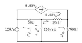
$$\frac{120}{s} = 50(I_1 - 0.05V_\phi) + \frac{250}{s}(I_1 - I_2)$$
