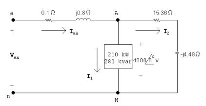
$S_{\phi}(\text{load}) = 4206.3 + j1773.6 \,\text{kVA}$
