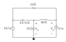
$$\frac{V_1}{10} + \frac{V_1 - 50/s}{25/s} + \frac{V_1 - V_o}{4s} = 0$$
