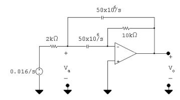
$$\frac{V_{\rm a} - 0.016/s}{2000} + \frac{V_{\rm a}s}{50 \times 10^6} + \frac{(V_{\rm a} - V_o)s}{50 \times 10^6} = 0$$
