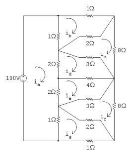
$$\begin{split} 100 &= 6i_a - 1i_b + 0i_c - 2i_d - 2i_e + 0i_f - 1i_g \\ 0 &= -1i_a + 4i_b - 2i_c + 0i_d + 0i_e + 0i_f + 0i_g \\ 0 &= 0i_a - 2i_b + 13i_c - 3i_d + 0i_e + 0i_f + 0i_g \\ 0 &= -2i_a + 0i_b - 3i_c + 9i_d - 4i_e + 0i_f + 0i_g \\ 0 &= -2i_a + 0i_b + 0i_c - 4i_d + 9i_e - 3i_f + 0i_g \\ 0 &= 0i_a + 0i_b + 0i_c + 0i_d - 3i_e + 13i_f - 2i_g \\ 0 &= -1i_a + 0i_b + 0i_c + 0i_d + 0i_e - 2i_f + 4i_g \end{split}$$
