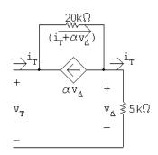
$$v_T = 20 \times 10^3 (i_T + \alpha v_\Delta) + 5 \times 10^3 i_T$$
