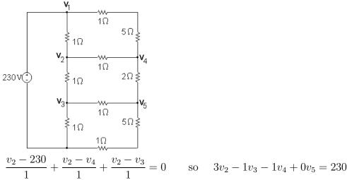
$$\frac{v_2 - 250}{1} + \frac{v_2 - v_4}{1} + \frac{v_2 - v_3}{1} = 0$$
