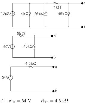
$$v_{\text{Th}} = 54 \text{ V}$$
