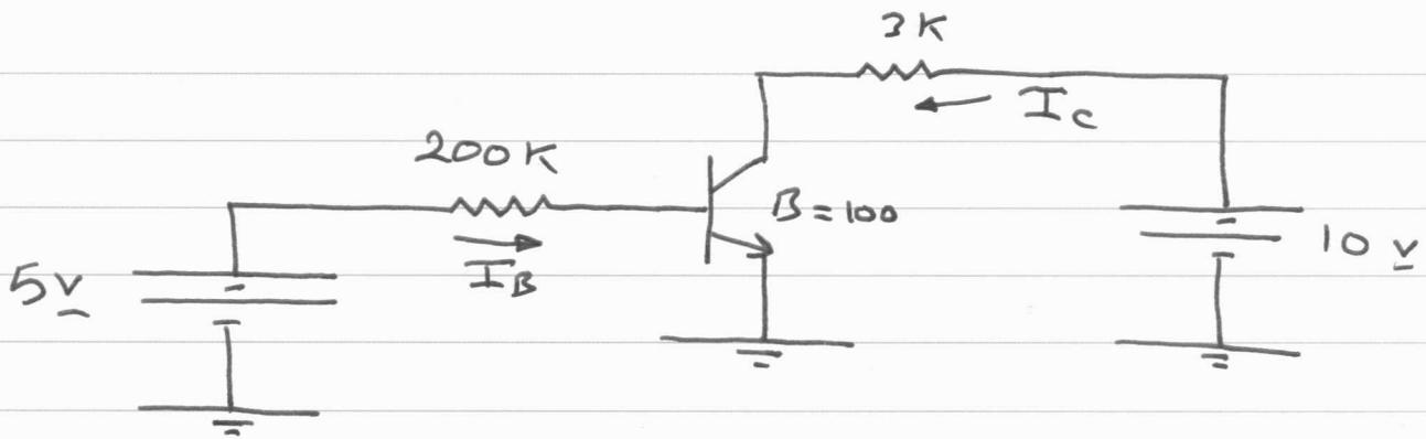
$$KVL : 5 = 200k I_B + V_{BE}$$
