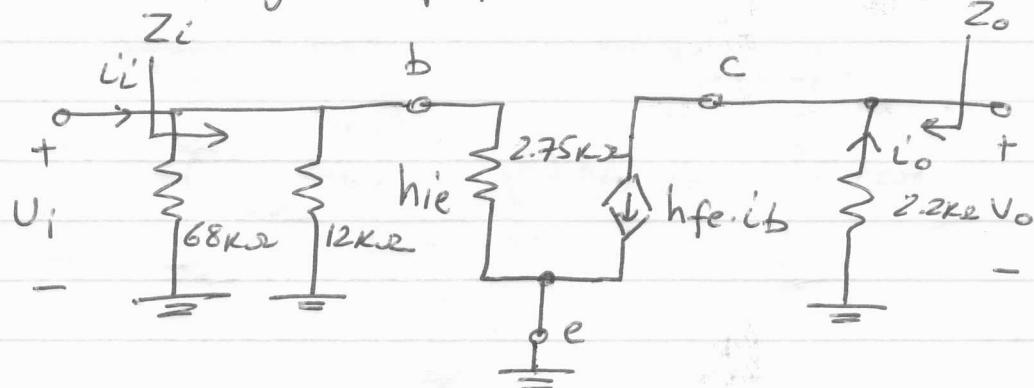
$$(a) Z_i = 68\text{k}\Omega // 12\text{k}\Omega // h_{ie} =$$
