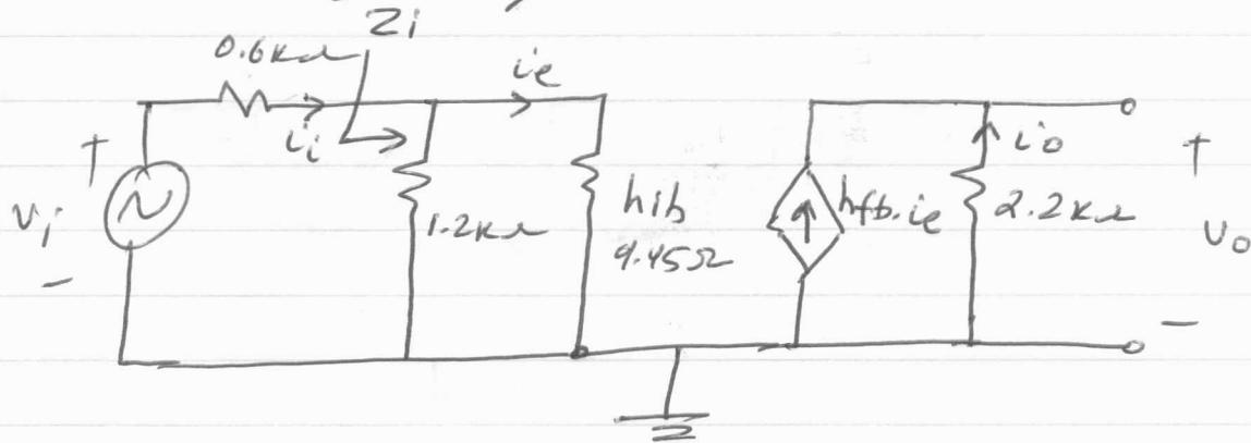
$$a) Z_i = 1.2k\Omega // h_{ib} = 1.2k\Omega // 9.45\Omega = 9.38 \Omega$$
