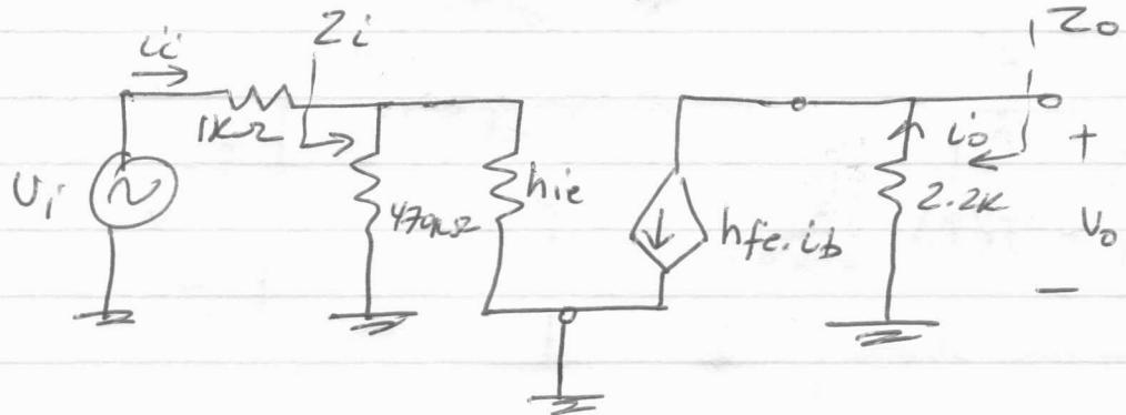
a)  $Z_i = 470k\Omega // h_{ie} = 470k\Omega // 0.86k\Omega = 0.858k\Omega$
