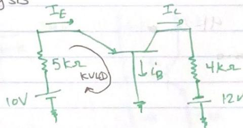
$$\text{KVL: } 10 = 5kI_{EQ} + V_{EB}$$
