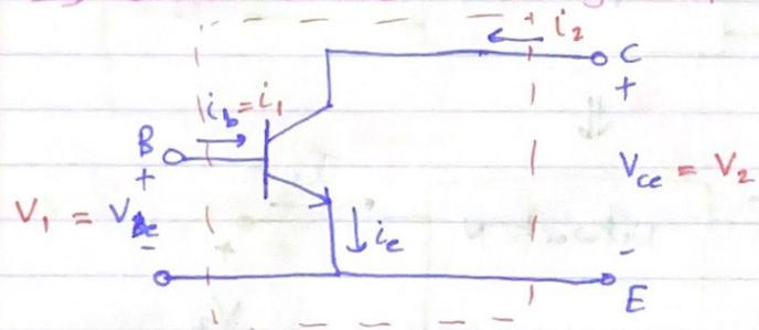
$$V_{be} = h_{ie} \cdot I_b + h_{re} \cdot V_{ce} \leftarrow \text{KVL}$$
