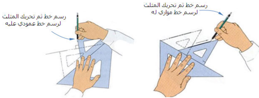
شكل 23: مسك، تثبيت وتحريك المثلثين لرسم الخطوط المتوازية والمتعامدة
