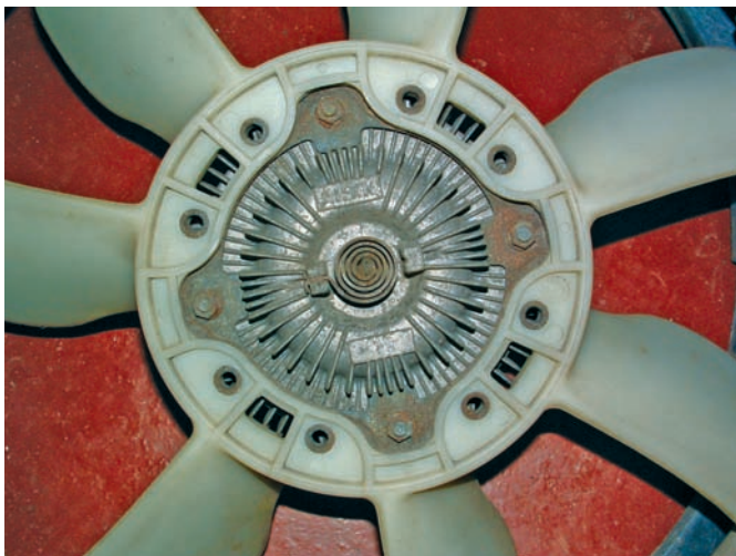
Figure 14-32 A viscous-type fan clutch.
