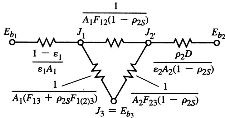
$$T_1 = 813 \text{ K} \quad \varepsilon_1 = 0.3 \quad T_2 = 533 \text{ K} \quad T_3 = 293 \text{ K} \quad \rho_{D2} = 0.2$$
