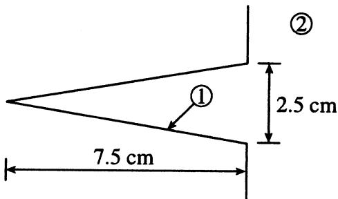
$$T_1 = 823 \text{ K} \quad \varepsilon_1 = 0.5 \quad T_2 = 0 \text{ K}$$
