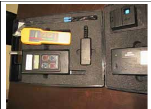
شكل (٤) الكيت (سالموراغي) المستخدم في قياس رطوبة الجدران ونسبة الأملاح عليها. تصوير الباحث، ١٩٩٩
