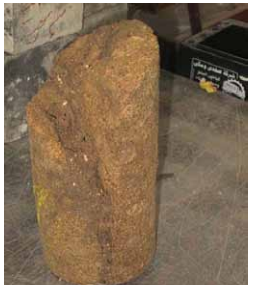
شكل (٦) إحدى العينات المستخرجة للفحص Core Test تصوير الباحث، ١٩٩٩
