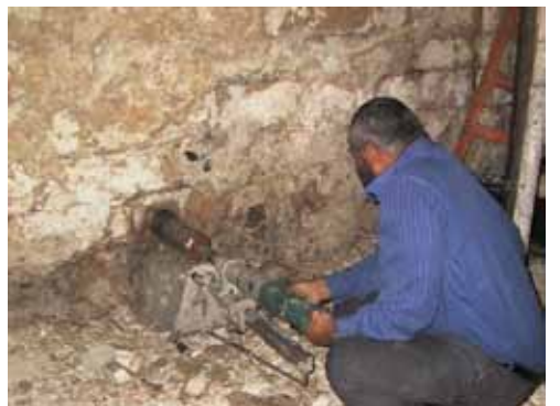
شكل (٥) مشرف مختبر المواد والتربة في الجامعة الإسلامية يأخذ عينة من الجدار لفحصها Core Test تصوير الباحث، ١٩٩٩
