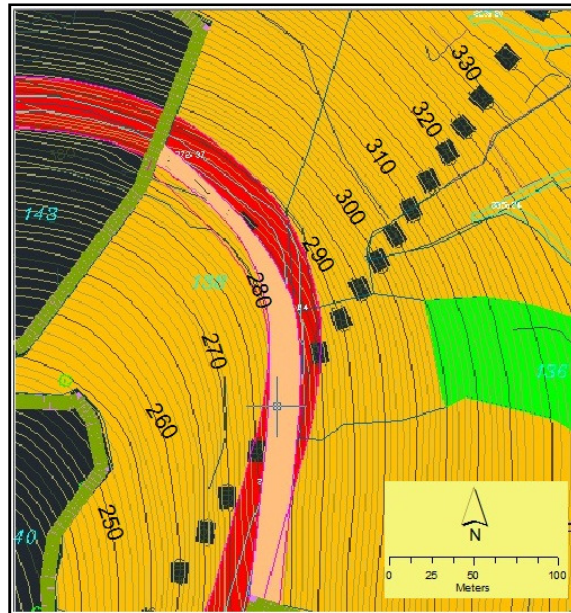
شكل ٤١: اختيار موقع الطريق مع الأخذ بالاعتبار طبوغرافيا المنطقة
